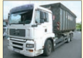
(Vol. 14+15+16) 3x vorhanden MAN TG-A 26.430 6x2 (E3+G1) Abrollkipper EZ: 12/2004-01.2005, zul. Gesamtgewicht: 26.000 kg, Nutzlast: 14.800 kg, abgel. Km-Stand: 309+330+405Tkm, Federung: Blatt/Luft, Aufbau: Meiller RK 20.70 für bis 7 m Container, 21.000 kg Hubkraft, Schubarm, Innenbedienung, Lg.Fhs/Liege, ABS, ASR, Klima, Dachluke, Radio, analoger Tacho,Lenk+ Liftachse, Diff.-Sperrung HA, AHK 2-Leiter Luftanschluss, etc.
